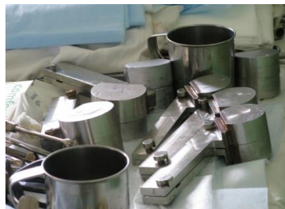
Рис. 10. Набір прес-форм семи типорозмірів для інтраопераційного виготовлення спейсерів кульшового суглоба
