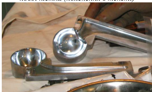
Рис. 6. Прес-форма для інтраопераційного виготовлення спейсера
