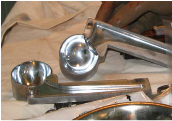
Рис. 2. Прес-форма для інтраопераційного виготовлення спейсера
